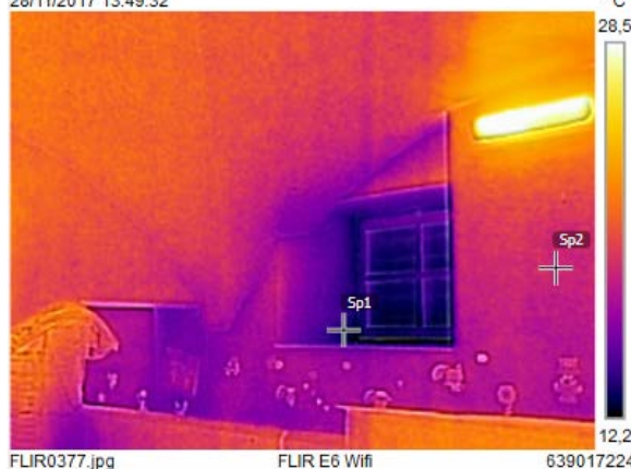
Figura 4.5 – Rilievo termografico dei serramenti – piano ammezzato, locale refettorio
